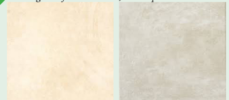
Enduit taloché fin avec badigeon à la chaux, deux teintes différentes
